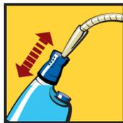
2. Abaisser le dispositif de dosage avec la pièce à main d'aspiration posée ou à la main
